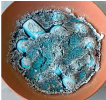
Resim-8 Pişirim sonrası kuru sır harmanı ve boncuklar Picture-8 The dry glaze mix and beads after firing
