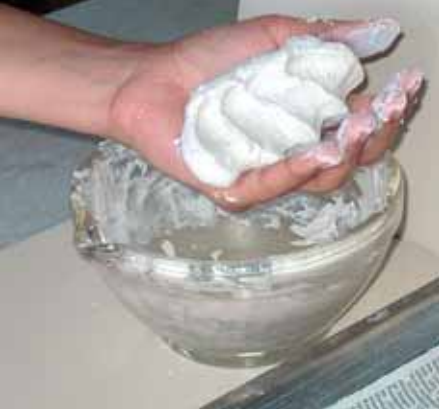
Resim-1 Şekillendirilmeye hazır kuvars hamuru Picture-1 Ready to be shaped quartz clay
