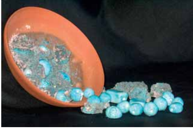
Resim-10 Boncukların kuru sır harmanından çıkarılması Picture-10 Removal of the beads from the dry glaze mix
